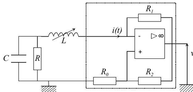
Le montage ci-dessus modélise un oscillateur à résistance négative. On donne  $C = 10 \text{ nF}$  ;  $R_0 = 3 \text{ k}\Omega$  ;  $R_1 = 20 \text{ k}\Omega$  ;  $R_2 = R = 10 \text{ k}\Omega$  et  $L =$  inductance variable.
