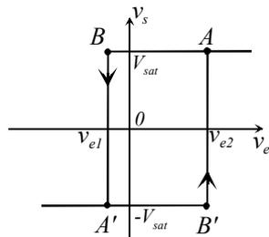
Caractéristique statique de transfert d'un comparateur non inverseur à hystérésis
