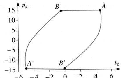
Comparateur simple (AO 741) soumis à un signal sinusoïdal de fréquence  $5 \text{ kHz}$
