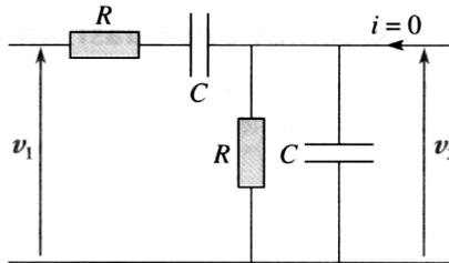
On considère le circuit ci-dessus (pont de Wien). La fonction de transfert est donnée par (pont diviseur de tension) :
