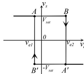
Caractéristique statique de transfert d'un comparateur inverseur à hystérésis
