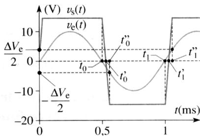
Réponse d'un comparateur simple non inverseur à A.O. (type 741) soumis à une commande sinusoïdale de fréquence  $f = 1 \text{ kHz}$ .
