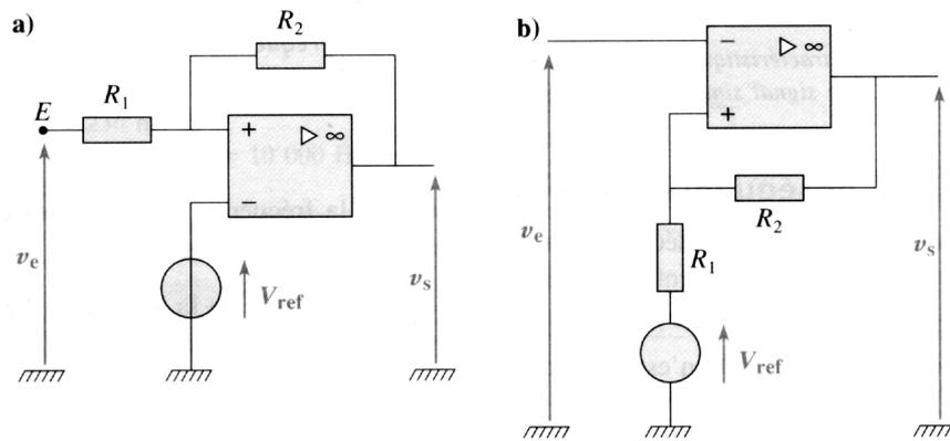
Comparateurs à hystérésis : a. non inverseur ; b. inverseur.
